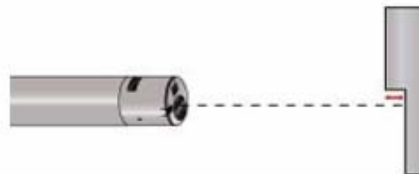
Figura No. 47: Medición de profundidad
