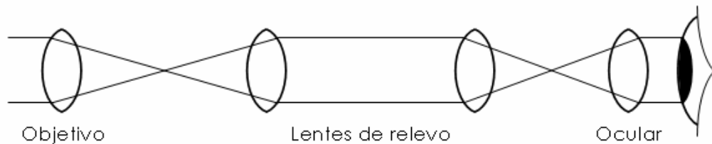
Figura No. 32: Sistema de imagen en un boroscopio
