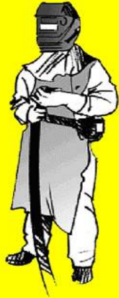
Fig.6 Protección para UV, RI y radiación de luz visible, con ropa adecuada como se detalla en la figura, usando delantal y guantes de cuero y casco de soldador.
