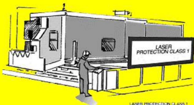
Fig.14 ESAB PRO-LAS 1® un sistema Láser con protección que muestra una combinación inteligente de seguridad y eficiencia para protección Láser clase 1
