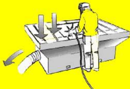
Fig.12 Mesa de corte suministrada con extracción de humos y gases
