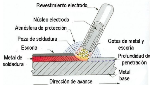
Fig. 3.3.- Proceso arco manual (SMAW) con electrodo revestido.
