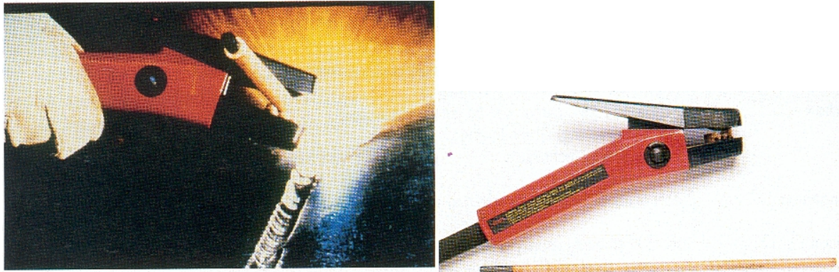
Figura 3.31 Proceso CAC-A y porta electrodo con varilla de grafito.
