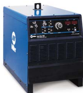
Figura 3.2 Fuente de poder típica en el proceso SMAW
